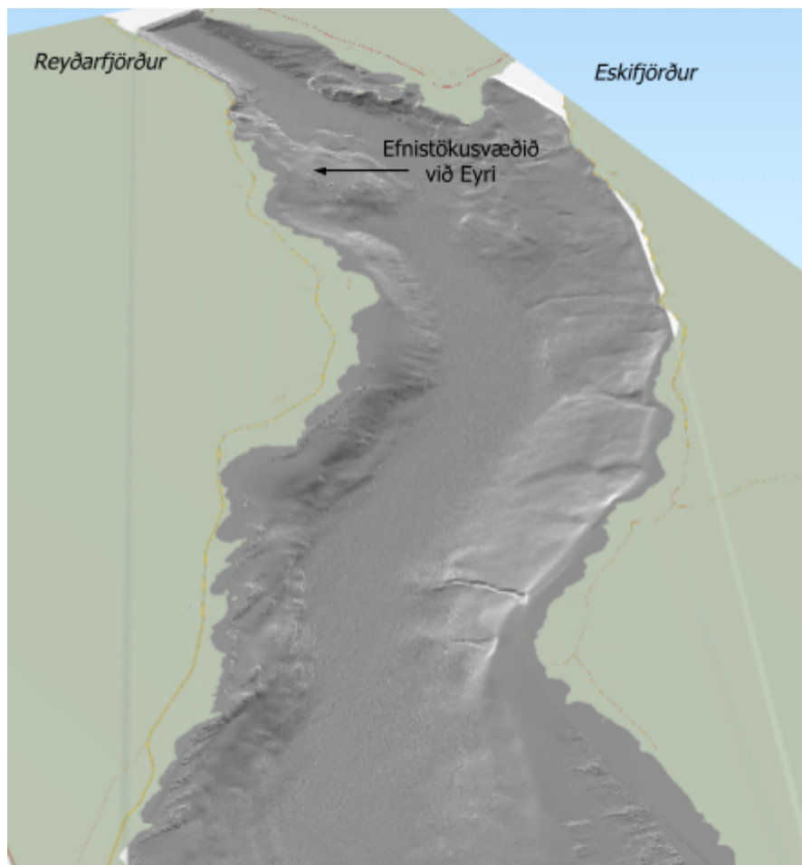
Mynd 3.2: Hér sést mynd sem gerð hefur verið af landlíkani af botni Reyðarfjarðar, unnið úr fjölgeislamælingum frá Sjósmælingarsviði Landhelgisgæslunnar. Líkanið gefur allgóða mynd af botni Reyðarfjarðar og landslaginu neðansjávar. Þarna sést m.a. að setlög er víða að finna á svipuðu dýpi. Sjá einnig mynd 3.3.
